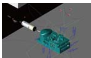
図10 自動的に最適化された測定パス
