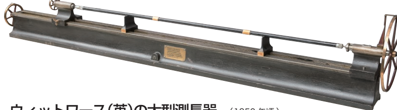
ウィットワース(英)の大型測長器 (1850年頃)
